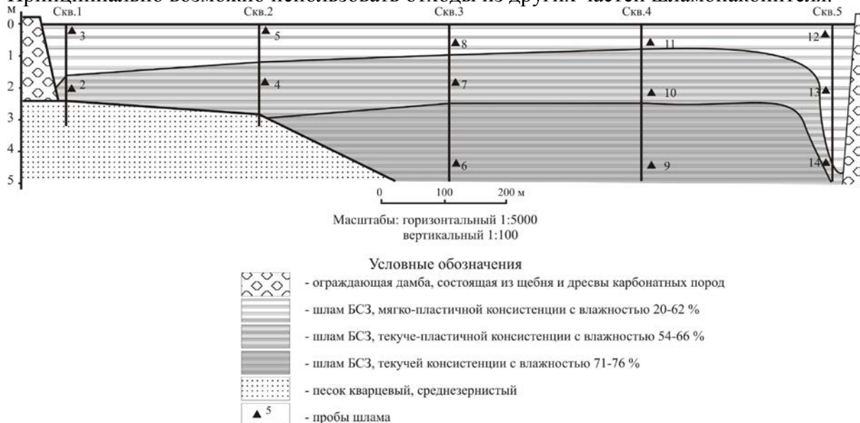
Рис. 4. Разрез старой карты шламонакопителя ОАО «Березниковский содовый завод».
